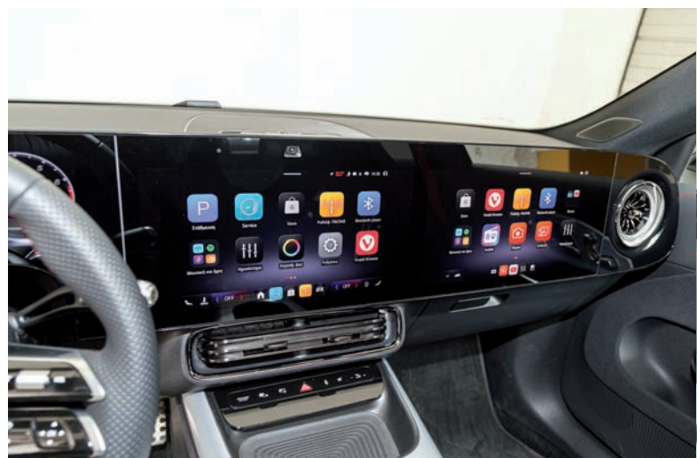
Κεντρική οθόνη 14 ιντσών, στις πλουσιότερες εκδόσεις προστίθεται άλλη μία μπροστά από τον συνοδηγό.
