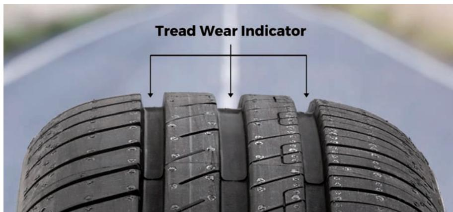
τος βρίσκεται μία σειρά δεικτών φθοράς. Τέλος, αξίζει να τονίσουμε ότι το επαρκές βάθος αυλακώσεων είναι πολύ σημαντικό για την ασφαλή οδήγηση. Αυτός είναι ο τρόπος διαφυγής του νερού σε μία βρεγμένη επιφάνεια ώστε να μην εμφανίστούν φαινόμενα υδρολίσθησης και απώλειας πρόσφυσης. ♦
